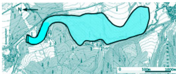
Ausdehnung des Rückhaltebeckens bei Dauerstau und bei Vollstau (hellblau hinterlegt, umrandet), verändert nach Thüringer Landesvermessungsamt (1999)
